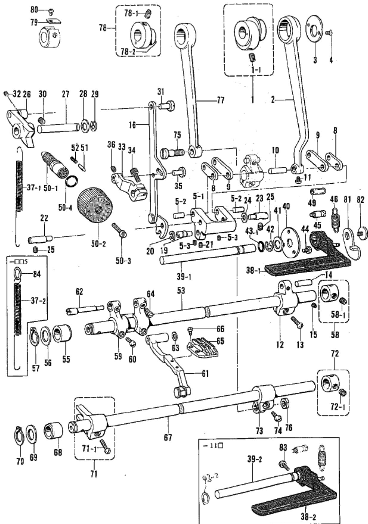
Mécanisme de l'entraînement/Mecanismo de la alimentación
