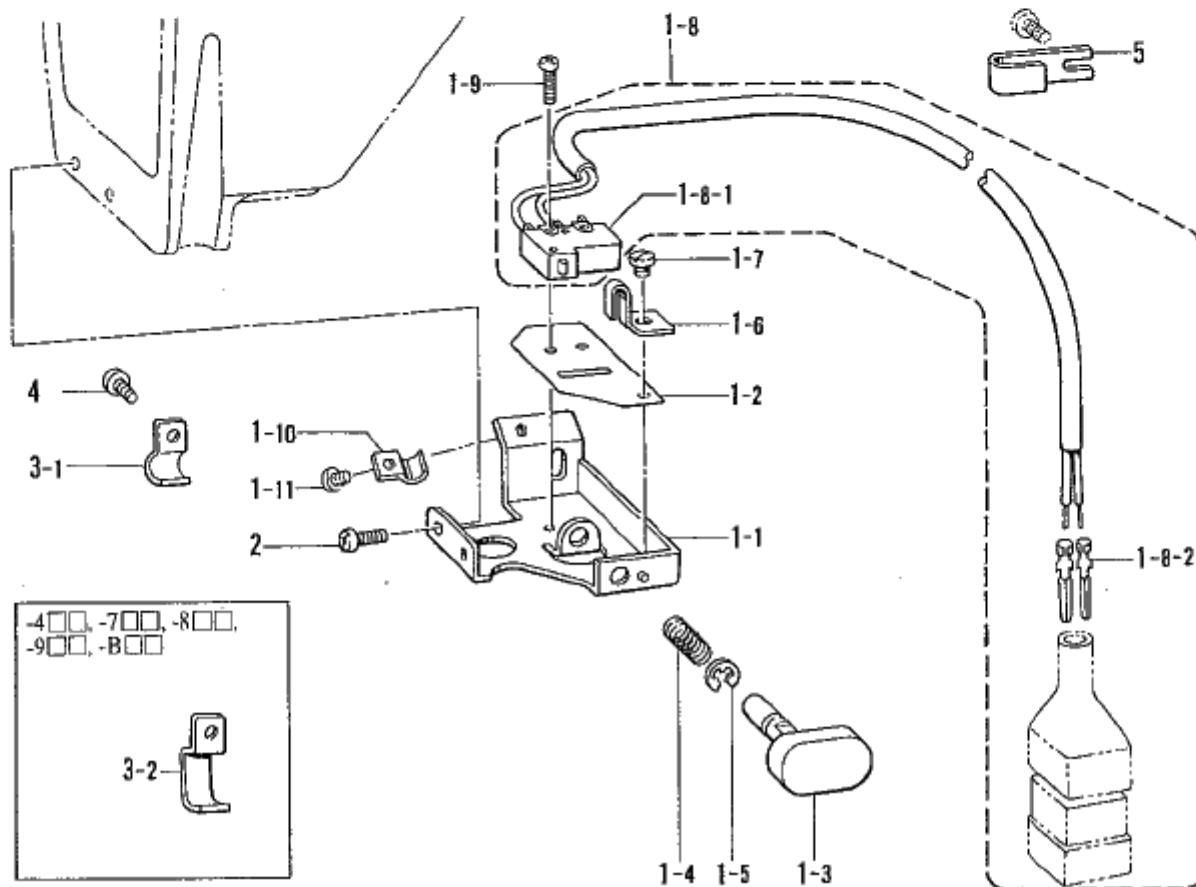
Mécanisme de interrupteur de genou / Mecanismo del conmutador de rodilla
