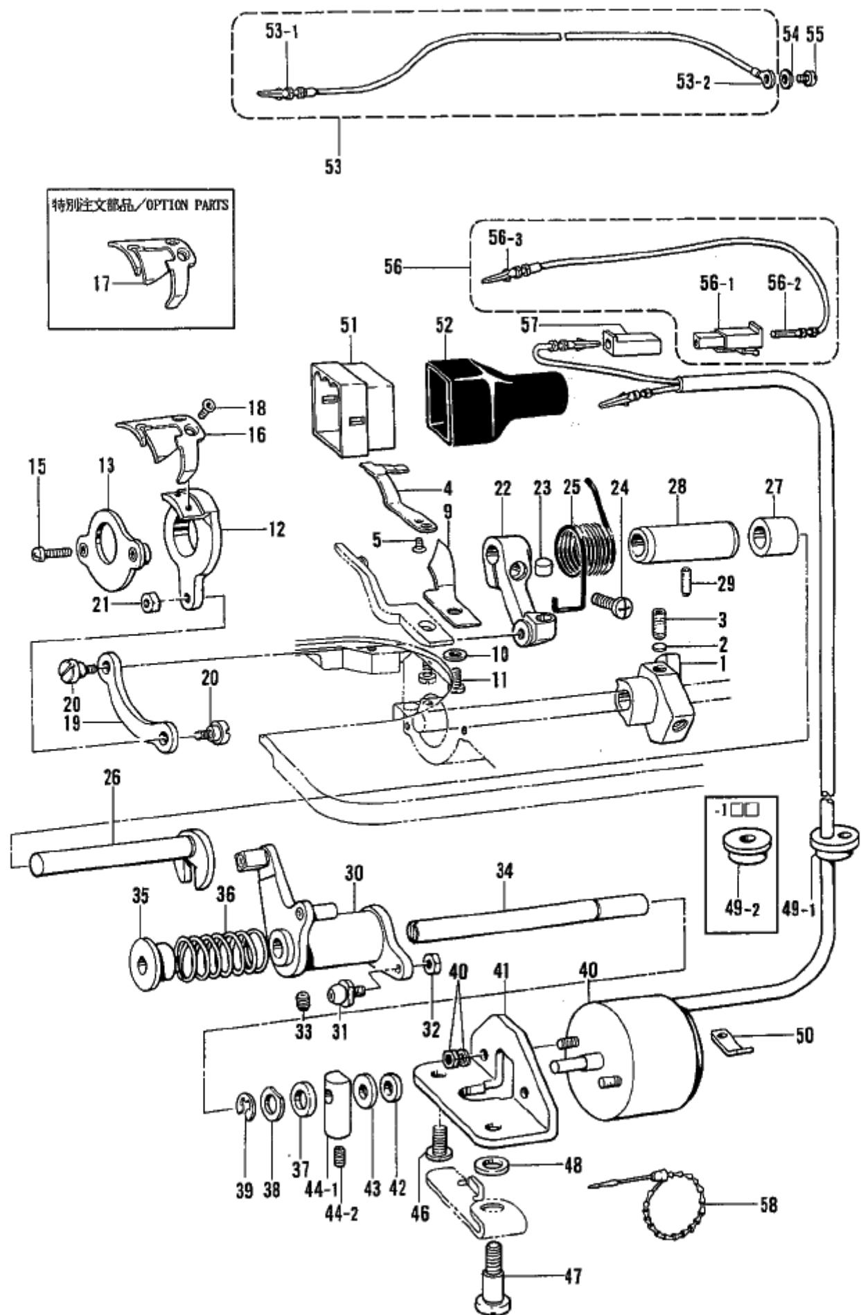
Mécanisme de coupe-fil/Mecanismo de la cortadura de hilos
