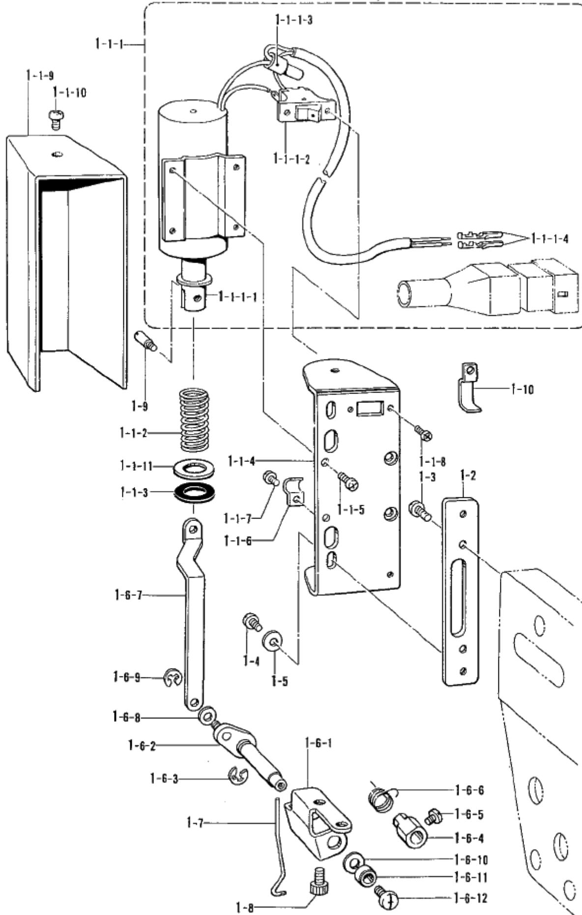
Mécanisme de tire-fil/Mecanismo de limpiador de rulos
