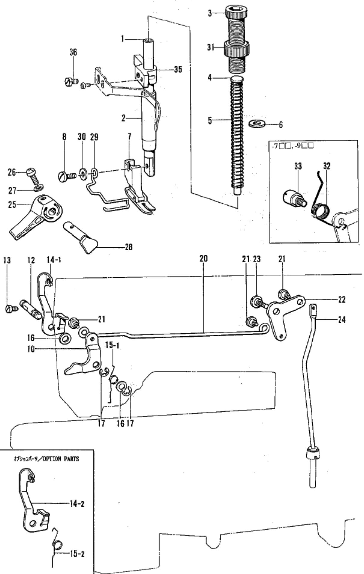
Mécanisme du pied presseur/Mecanismo del prensatelas
