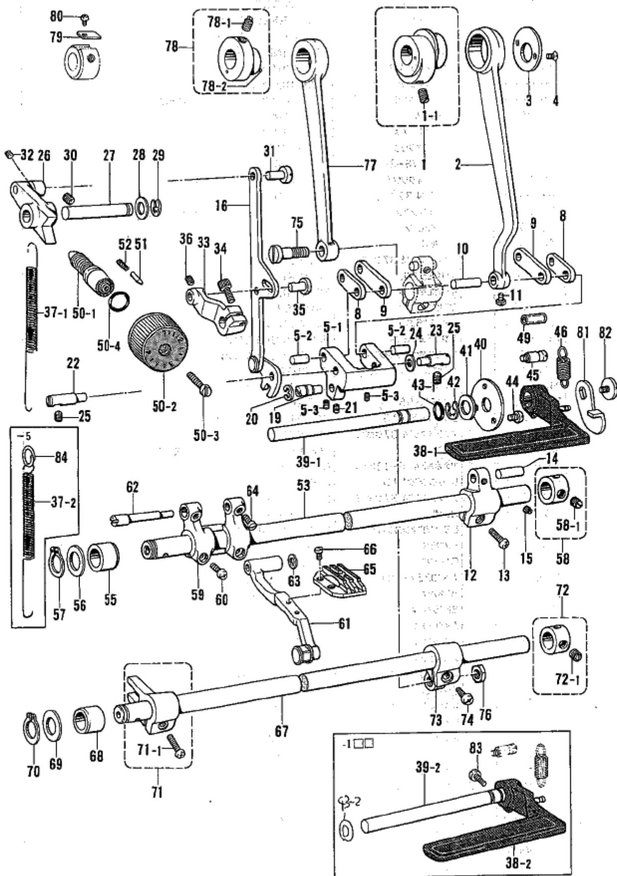
Mécanisme de l'entraînement/Mecanismo de la alimentación
