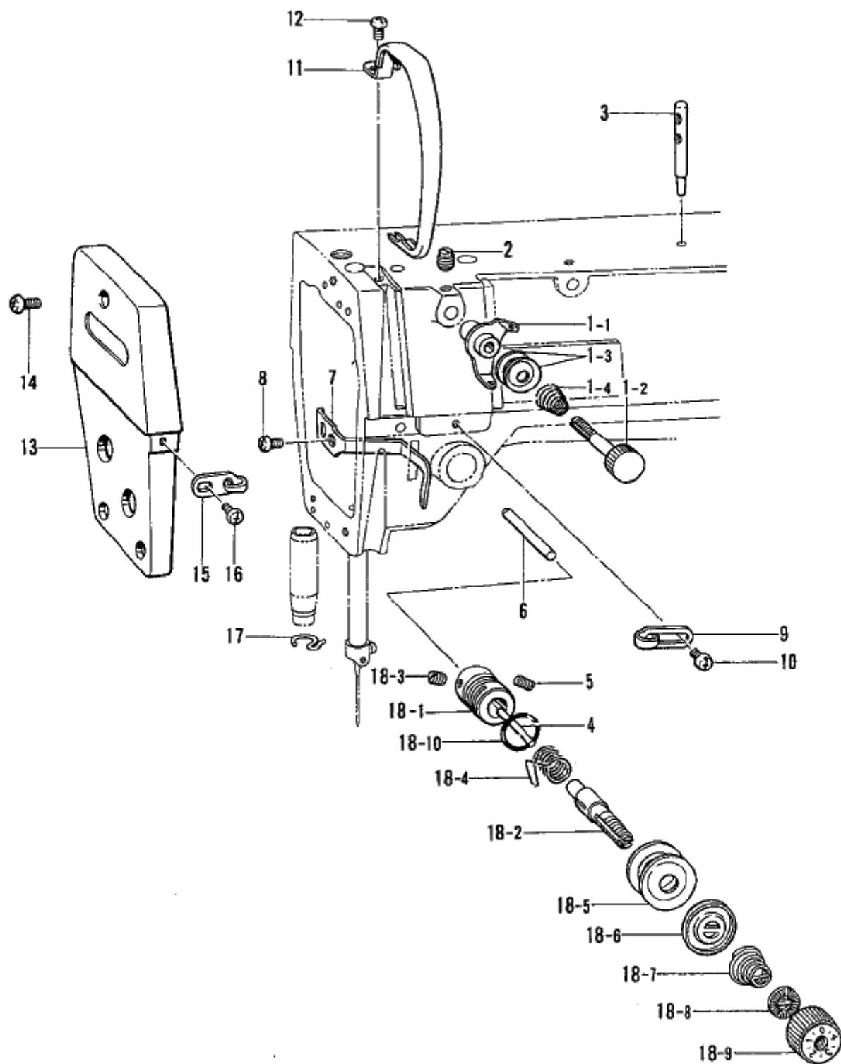
Mécanisme de l'enfilage/Mecanismo del enhebrado
