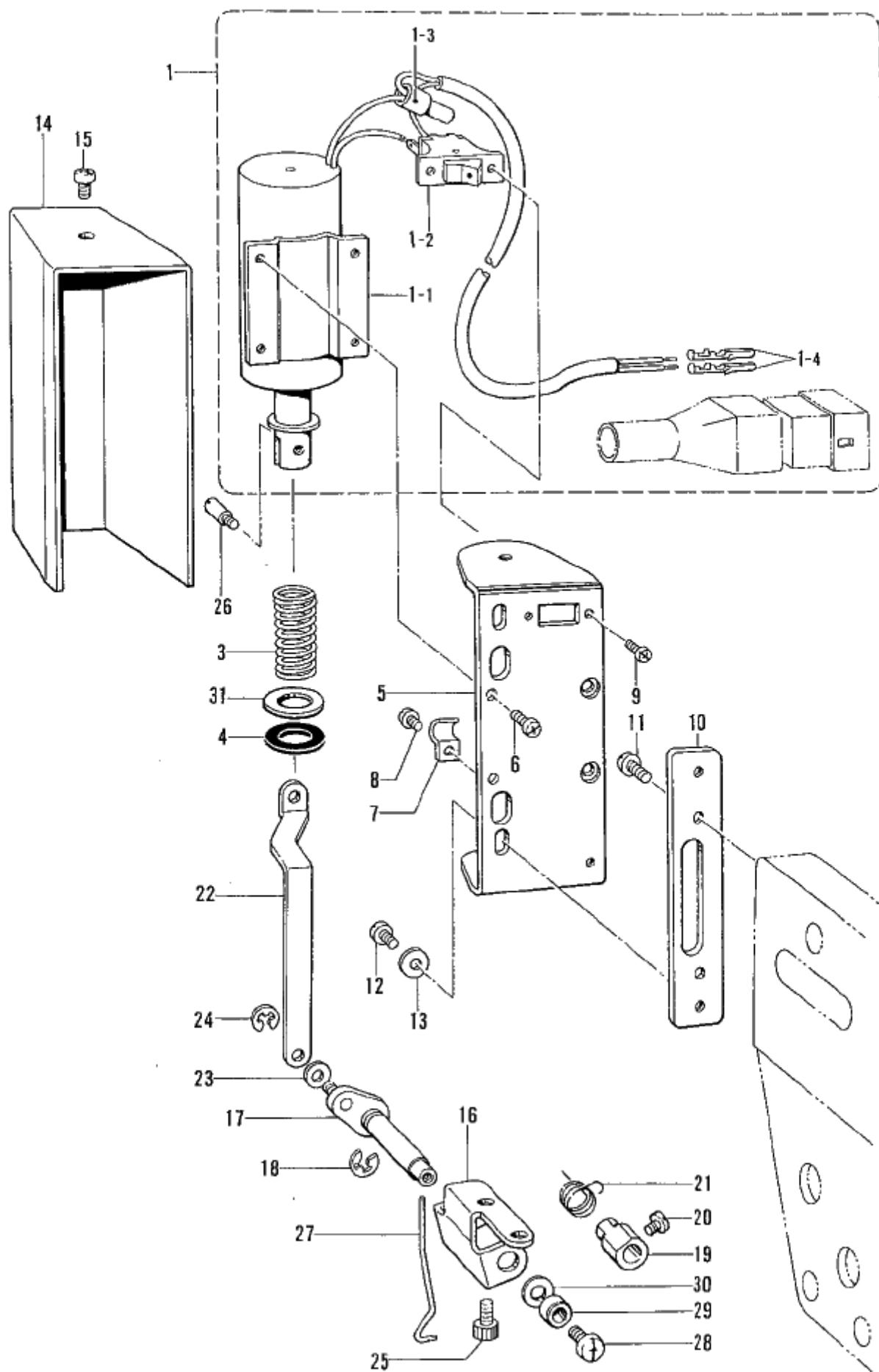
Mécanisme de tire-fil/Mecanismo del limpiador de hilos
