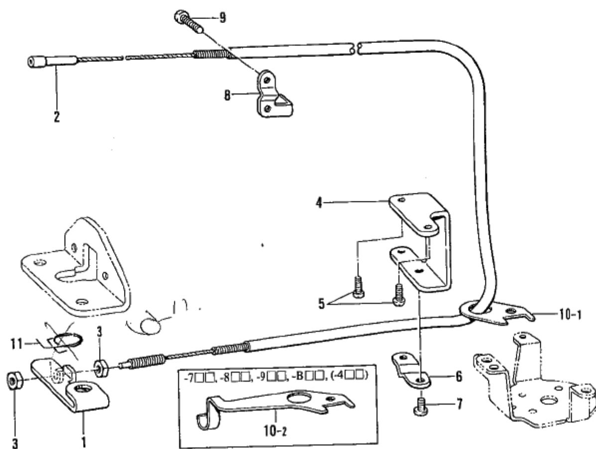
**Mécanisme de marche arrière rapide/Mecanismo de la inversión rápida**
