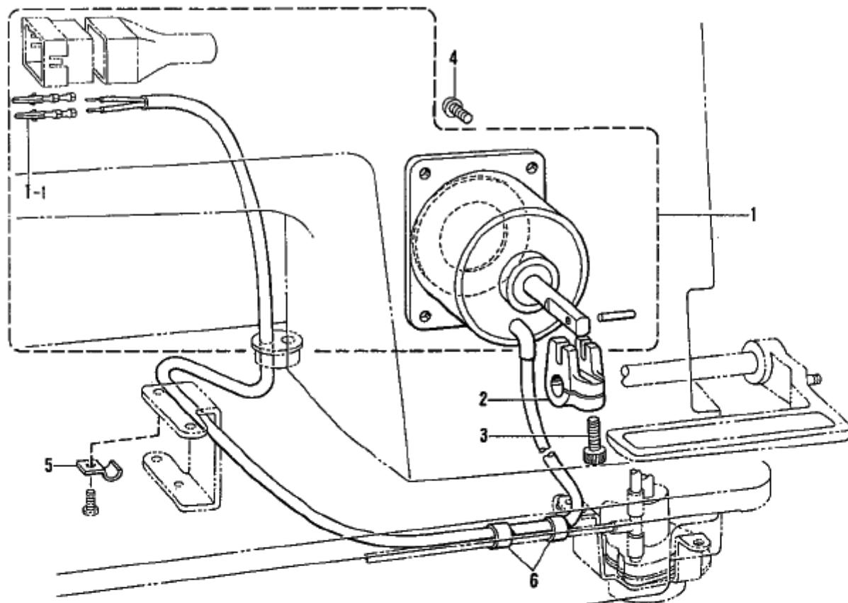
**M. 紐ユルメ関係/Tension release mechanism/Spannungsverminderungsvorrichtung/
