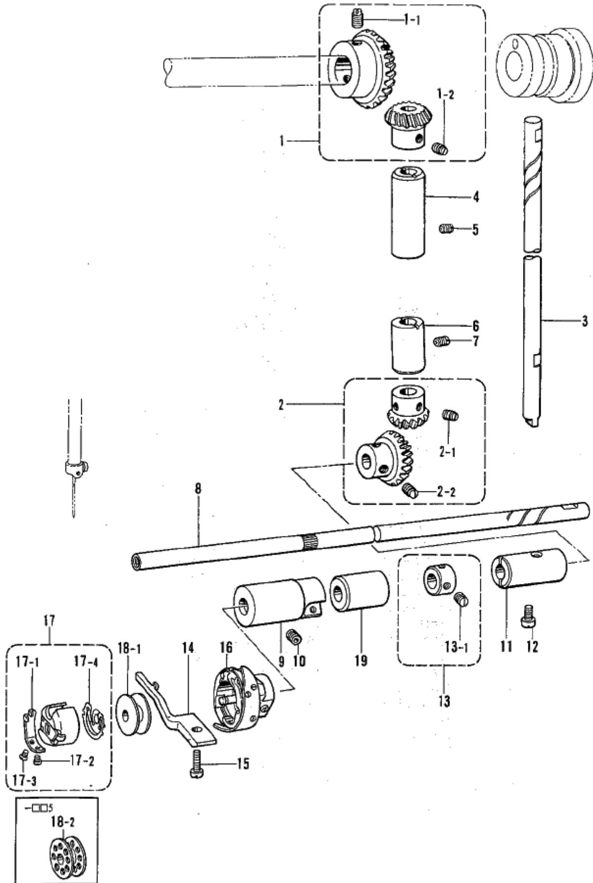
Mécanisme du crochet rotatif/Mecanismo del cangrejo
