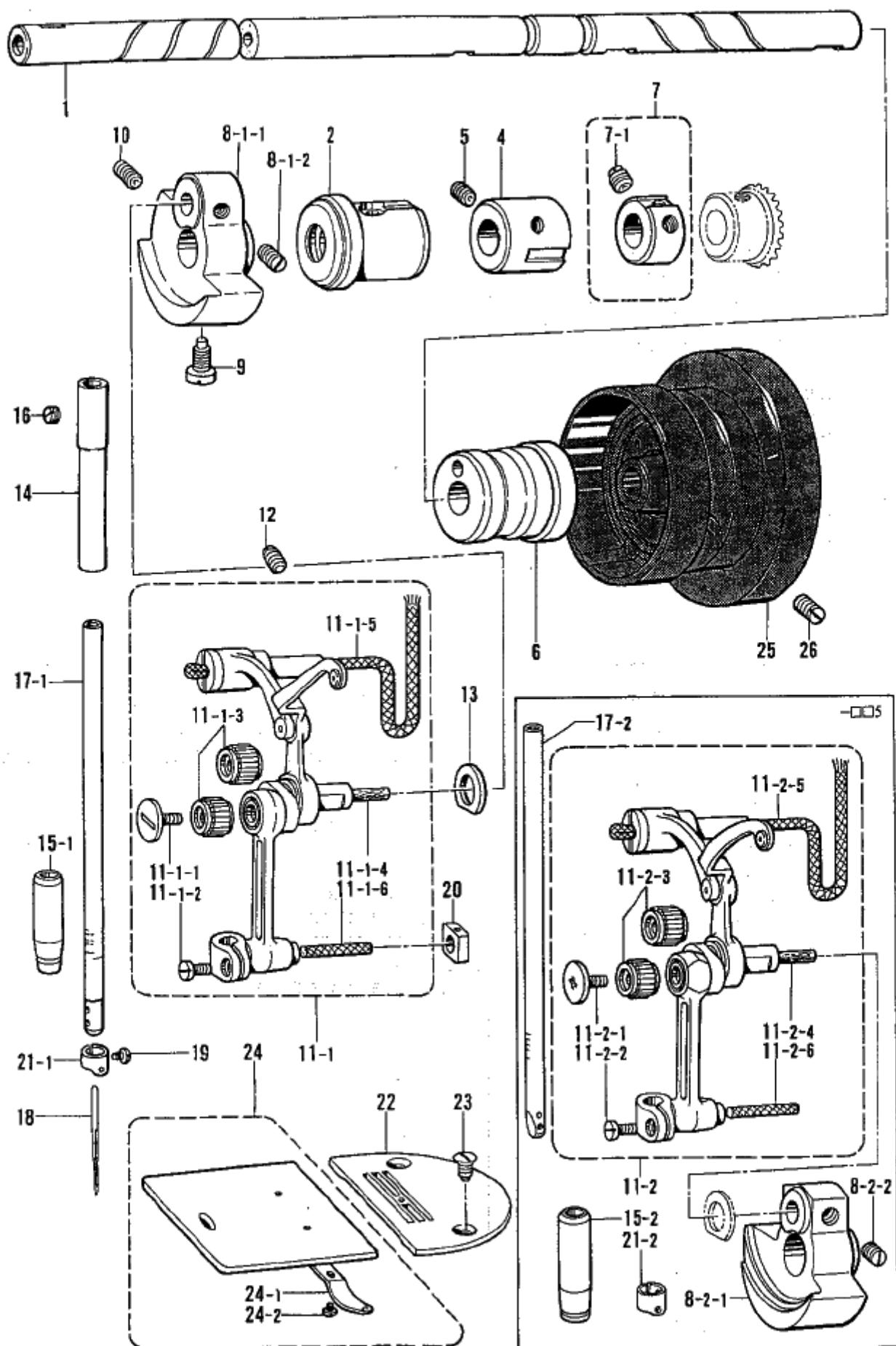
Mécanisme de la barre à aiguille et releveur de fil/Mecanismo de la barra de aguja y tirahilos
